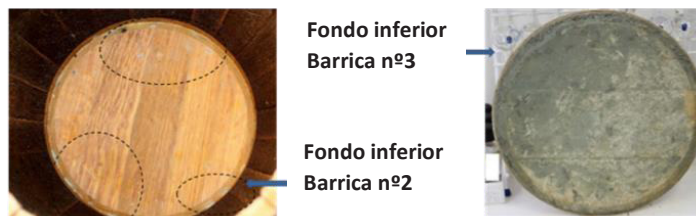
Figura 2. Estado de los fondos de las barricas 2 y 3 luego de haber sido desarmadas.
