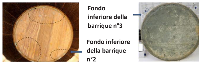
Figura 2. Condizioni del fondo delle botti 2 e 3 dopo essere state smontate.
