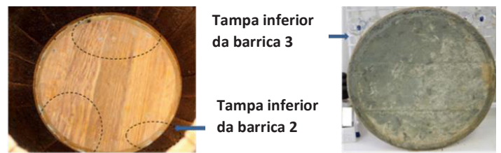
Figura 2. Estado das tampas das barricas 2 e 3 após a desmontagem.
