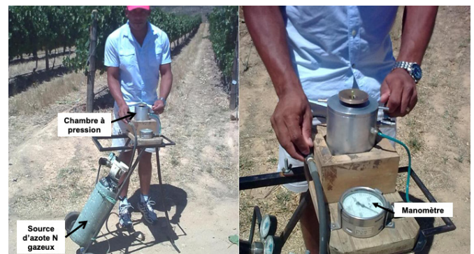
Figure 1. Exemple d'une chambre à pression utilisée pour la mesure du potentiel hydrique foliaire (© A. Deloire, Afrique du Sud).
