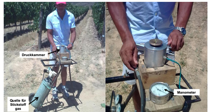
Abbildung 1. Beispiel einer Druckkammer zum Messen des Blattwasserpotenzials (Foto A. Deloire, Südafrika).
