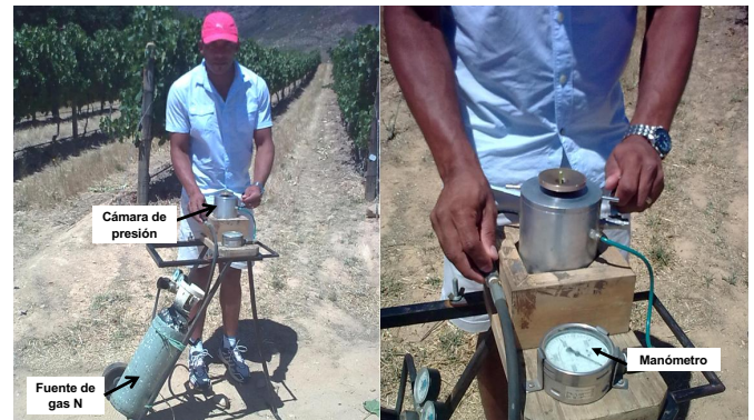
Figura 1. Ejemplo de cámara de presión usada para medir el potencial hídrico foliar (foto de A. Deloire, Sudáfrica).
