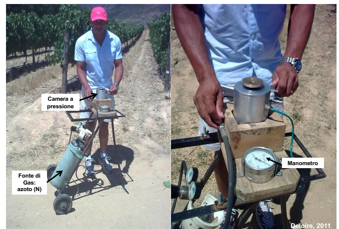
Figura 1. Esempio di camera a pressione usata per misurare il potenziale idrico della foglia (foto di A. Deloire, Sud Africa).
