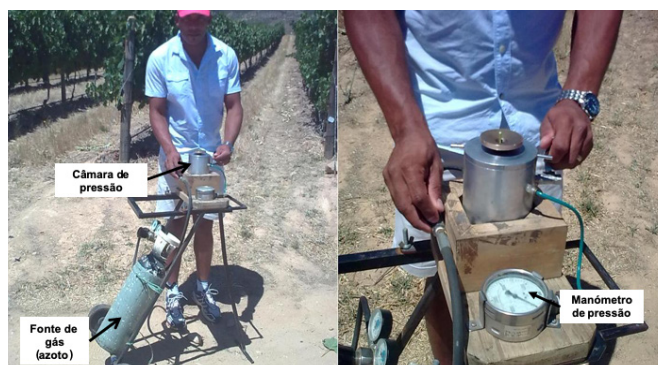
Figura 1. Exemplo de uma câmara de pressão utilizada para medir o potencial hídrico foliar (foto de A. Deloire, África do Sul).
