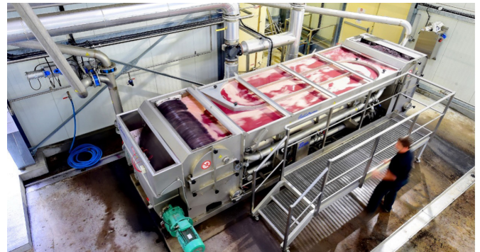
Figure 1. Exemple d'équipement de thermovinification ouvert, avec une large surface d'évaporation, développé pour favoriser l'élimination de la 3-isobutyl-2-méthoxy-pyrazine (IBMP). (©Claude Cruells).
