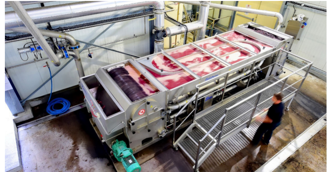
Abbildung 1. Beispiel einer offenen Thermovinifizierungsanlage mit einer großen Verdampfungsoberfläche, die die Eliminierung einer beträchtlichen Menge an 3-Isobutyl-2-methoxy-pyrazin ermöglicht (©Claude Cruells).
