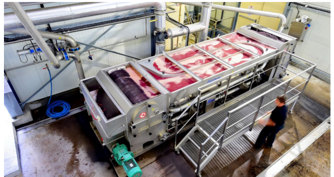
Figura 1. Esempio di un impianto di termovinificazione aperto con un'ampia superficie di evaporazione che consente l'eliminazione di una notevole quantità di 3-isobutil-2-metossipirazina (©Claude Cruells).
