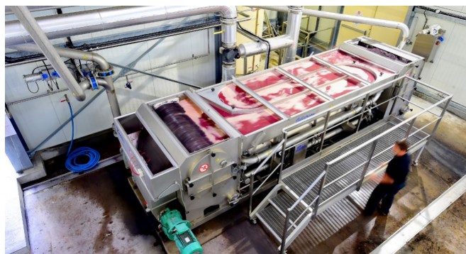
Figura 1. Exemplo de um equipamento de termovinificação aberto, com uma grande superfície de evaporação que permite a eliminação de uma quantidade substancial de 3-isobutilo-2-metoxipirazina (©Claude Cruells).
