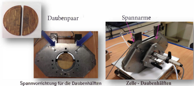
ABBILDUNG 2. Methodik zur Untersuchung des Daubenzwischenraum-Drucks. Diese Vorrichtung wurde speziell dafür entwickelt, um die Sauerstofftransferate über die Kontaktfläche zwischen den Dauben mithilfe eines Permeameters zu bestimmen. Ein Stück Eichenholzzaube wurde halbiert, und die beiden Hälften in einer Spannvorrichtung zusammengepresst.
