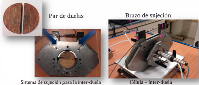
FIGURA 2. Metodología de estudio de la presión inter-duela. Este dispositivo fue especialmente concebido para evaluar la tasa de transferencia de oxígeno a través de los intersticios entre las duelas con el permeámetro. Un trozo de madera seleccionado fue cortado en dos, las dos mitades siendo presionadas una contra la otra en el sistema de sujeción.
