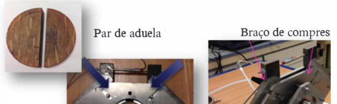
FIGURA 2. Metodologia para o estudo da pressão entre as aduelas. Este dispositivo foi especialmente concebido para testar a taxa de transferência de oxigénio através dos interstícios das aduelas com o permeâmetro. Um pedaço de carvalho selecionado foi cortado ao meio, sendo que as duas metades foram prensadas em conjunto no sistema de compressão.
